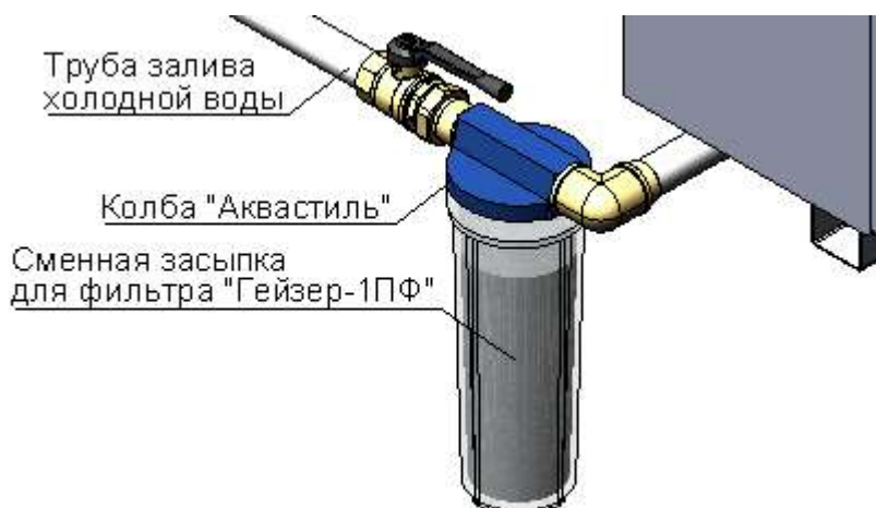
РИС. 10. УСТАНОВКА ФИЛЬТРА ДЛЯ ВОДЫ НА ТРУБУ ЗАЛИВА
