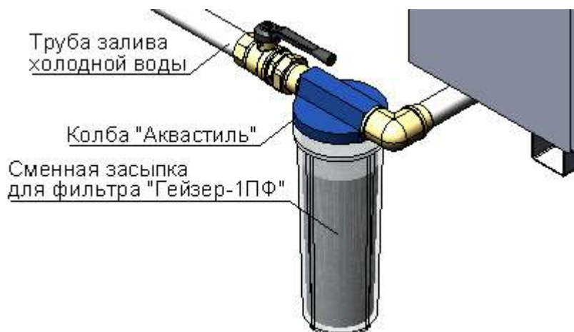
РИС. 13. УСТАНОВКА ФИЛЬТРА ДЛЯ ВОДЫ НА ТРУБУ ЗАЛИВА
